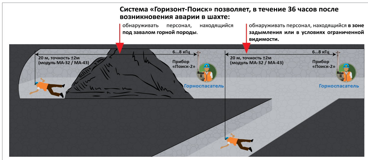
Рис. 5. Работа системы «Горизонт-Поиск» для определения местонахождения персонала при авариях в шахтах и рудниках
