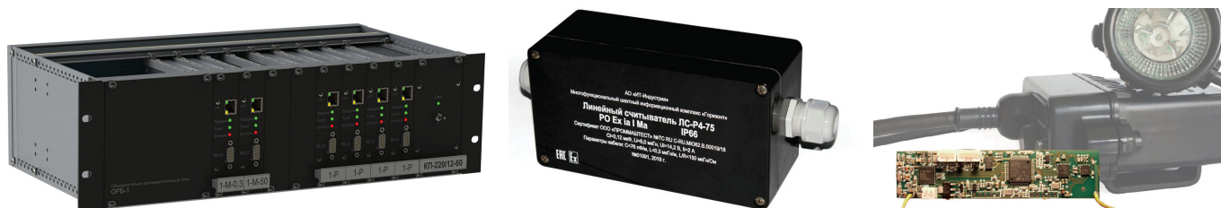
Рис. 1. Основные элементы сети позиционирования и аварийного оповещения комплекса «Горизонт» (слева направо): базовый контроллер, линейный считыватель и абонентский модуль горнорабочего
